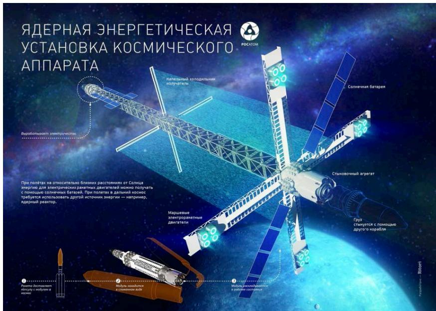
Рисунок 5. Ядерная энергетическая установка для межпланетных перелётов
