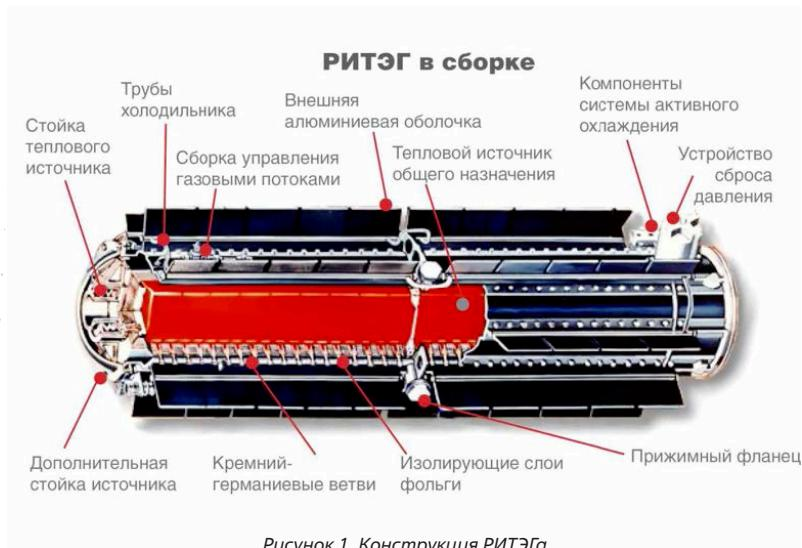
Рисунок 1. Конструкция РИТЭГа
